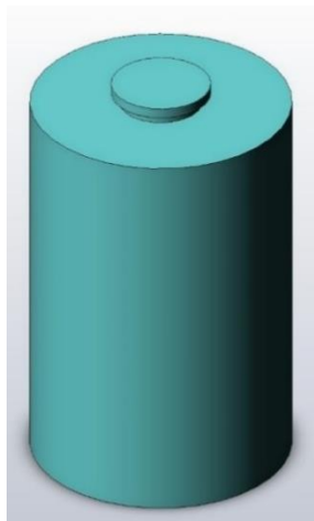
Рисунок 22. Общий вид бидона (первичная упаковка для РАО 1 класса)
