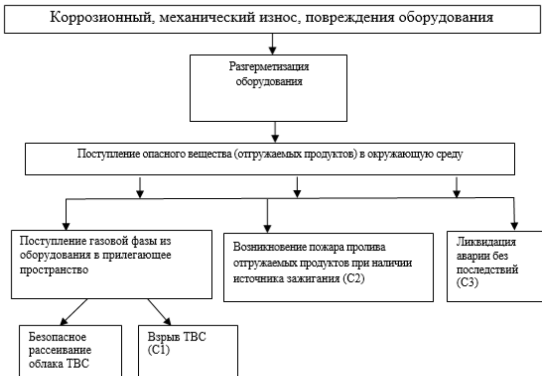
Рисунок 51. Блок-схема формирования сценариев аварии
