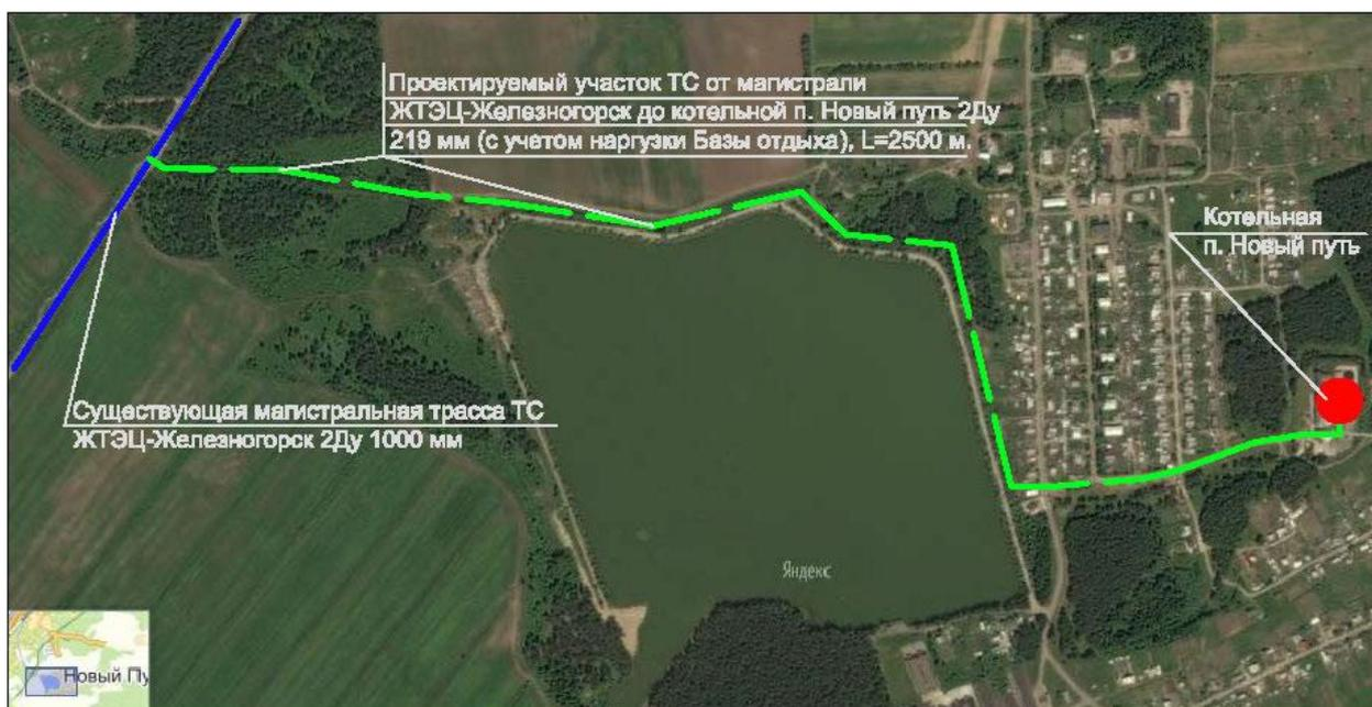
Рисунок 7.2. Трасса тепловой сети от тепломагистрали «Железногорская ТЭЦ – город» до котельной пос.Новый Путь
